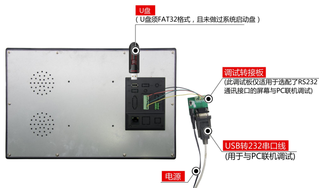
图 1-3 RS232 调试工具图
