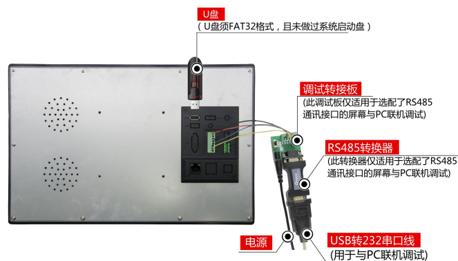
图 1-3 RS232 调试工具图
