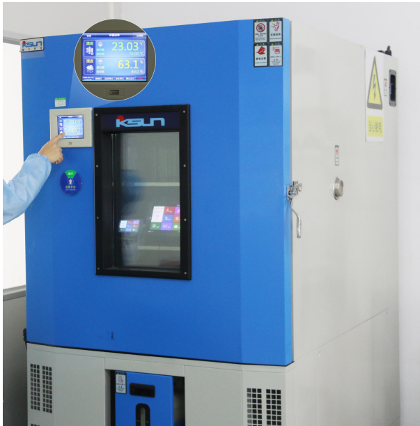
图 6-3 高低温老化测试图
